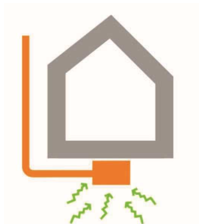
Figura 13: depressione del sottosuolo tramite pozzetto.
