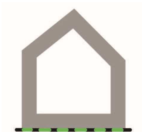
Figura 15: membrana impermeabile antiradon fra il terreno e l'edificio
